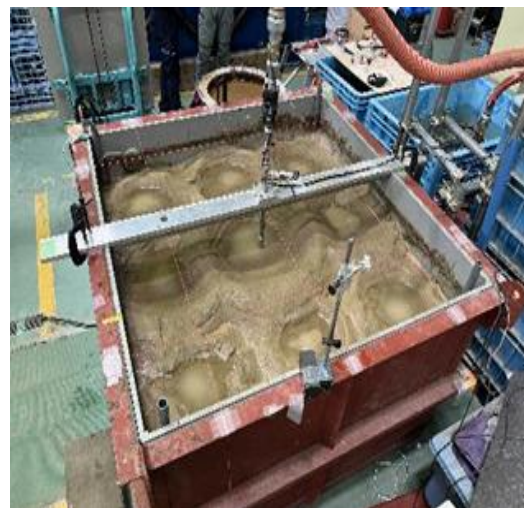
小型土槽実験全景
