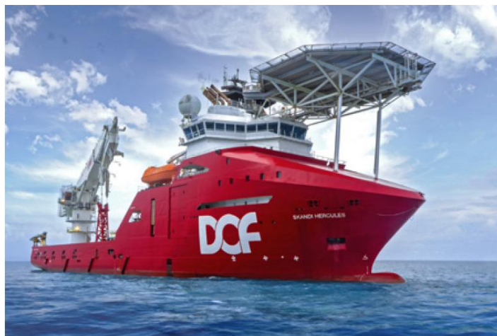
アンカーハンドリング船の例 (20,000PS級)
