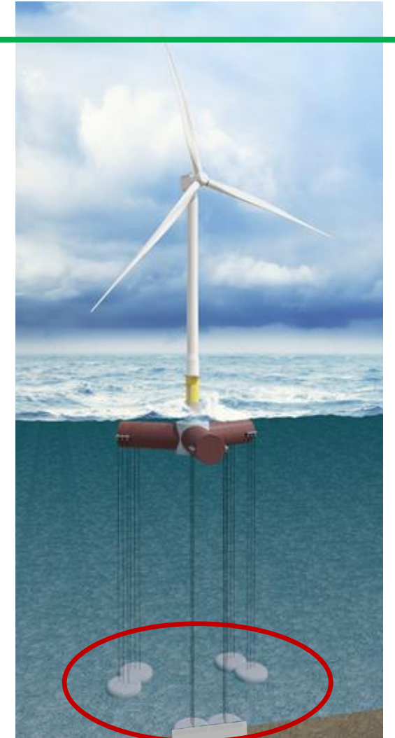
大水深無人化施工 (アンカー施工を対象)
