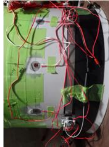
主軸部のひずみゲージ貼付状況
