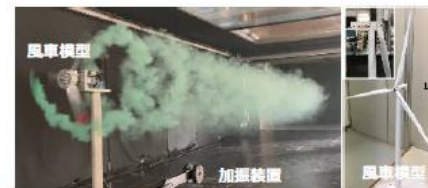
図2 浮体動揺を模擬した風洞実験
