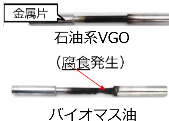
熱交試験後の 金属腐食
