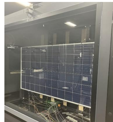
実用サイズモジュールの測定
