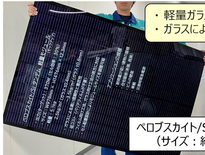
ペロブスカイト/Siタンデム 3D曲面モジュール (モックアップ) (サイズ：約80cm×65cm)
