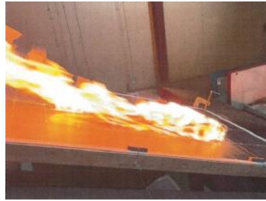
a. 火炎伝播試験 b. 飛び火試験 c. 裏面からの過熱試験
