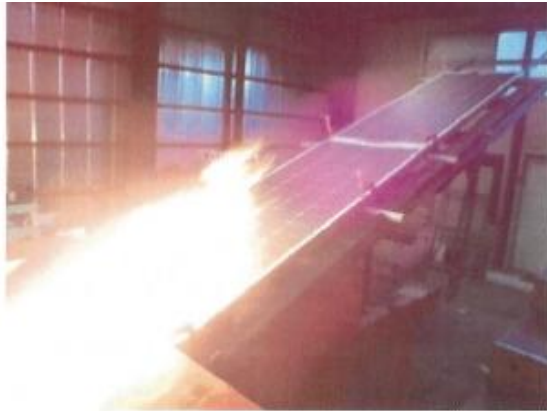
a. 火炎伝播試験 b. 飛び火試験 c. 裏面からの過熱試験
