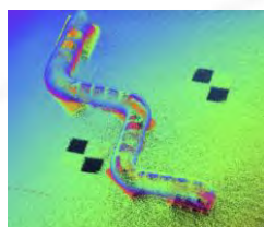
配管表面の温度異常検出
