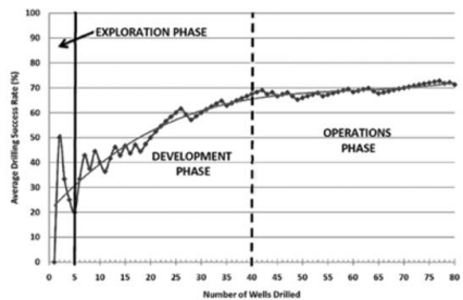
図4 カモジャンにおける坑井掘削数 n （横軸）と掘削成功率（縦軸）の推移（Sanyal, 2011）。
