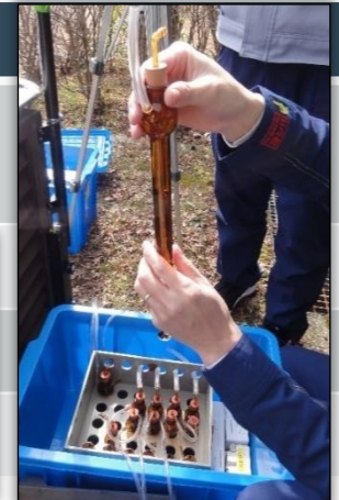
↑大気採取容器 (インピンジャー)の例
