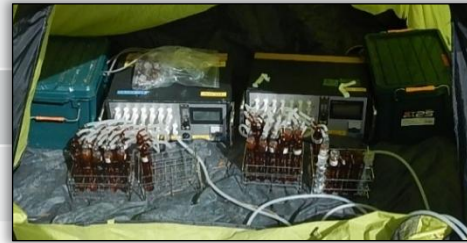
↑大気採取機材1地点分の例 (重量50 kg以上)
