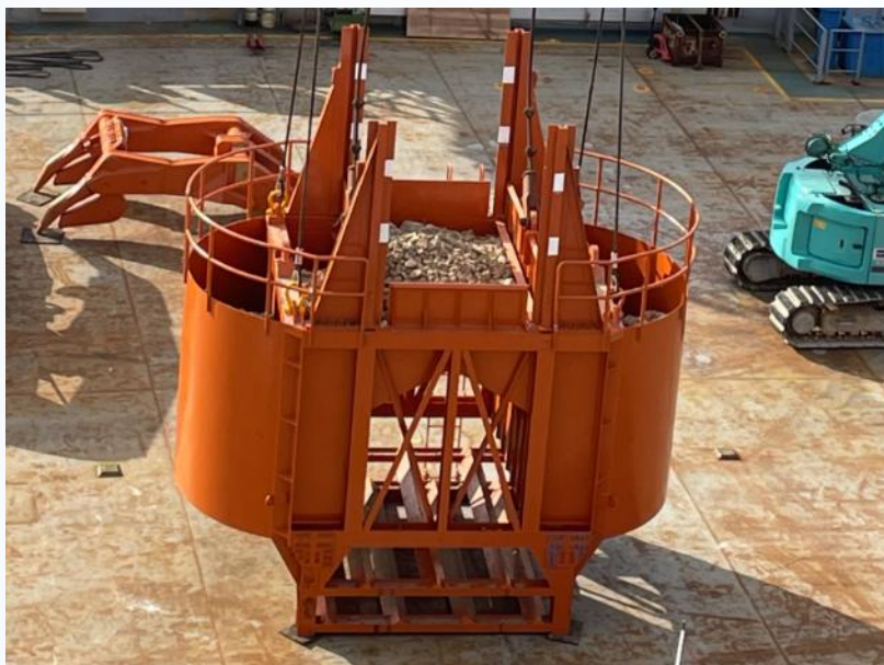
写真. 碎石防護装置
