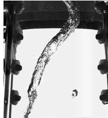
レーザー可視化システムによる粒子軌跡追跡法(PIV)結果
