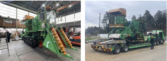
既存のケーンハーベスタをヤナギ収穫用に改造
