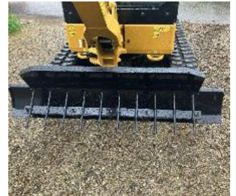
排土板を改造
