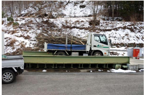
残材積み込み/計量
