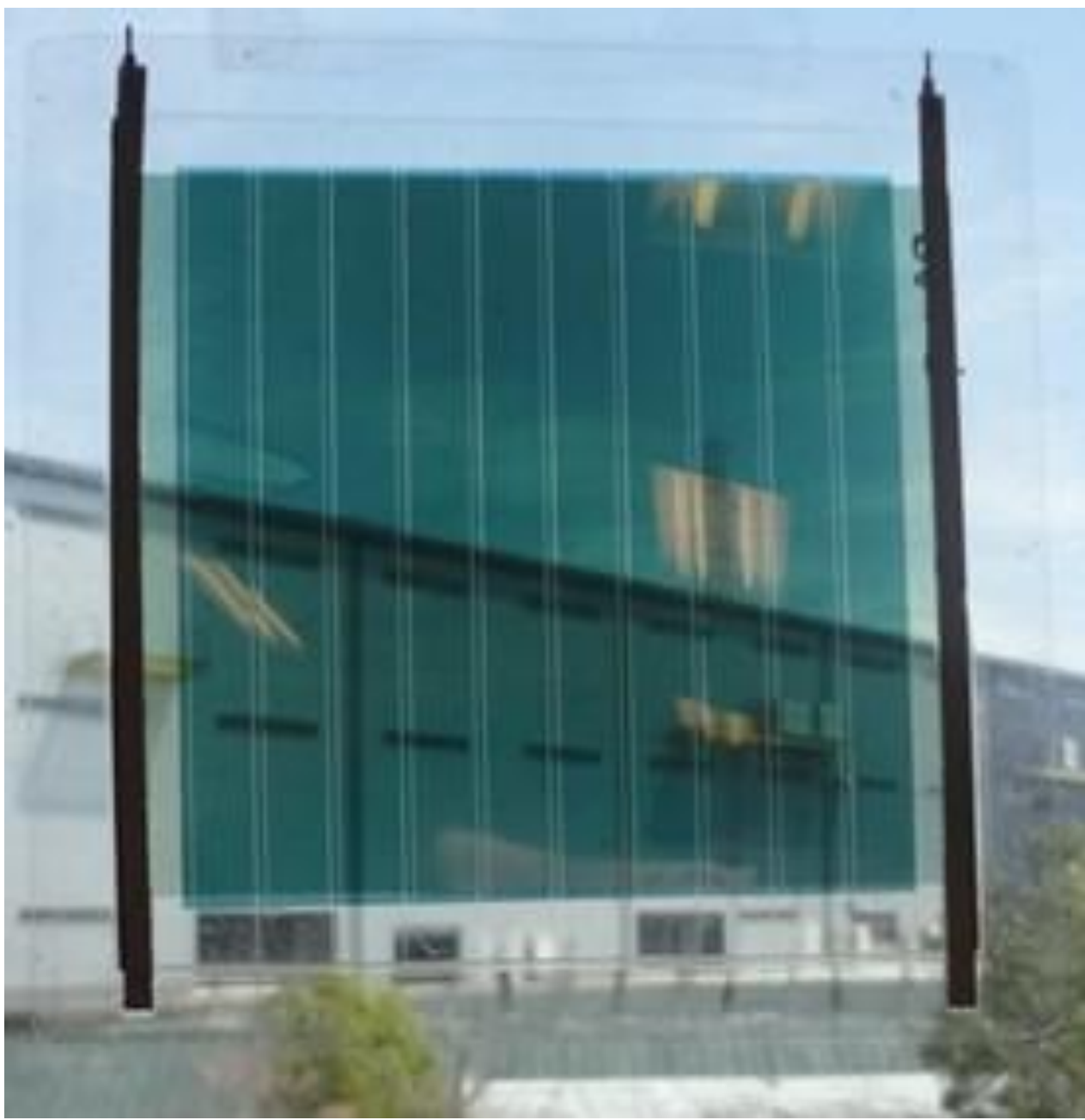
図2. 10cm角フィルム基板の透過型OPVモジュールのI-V特性と外観写真
