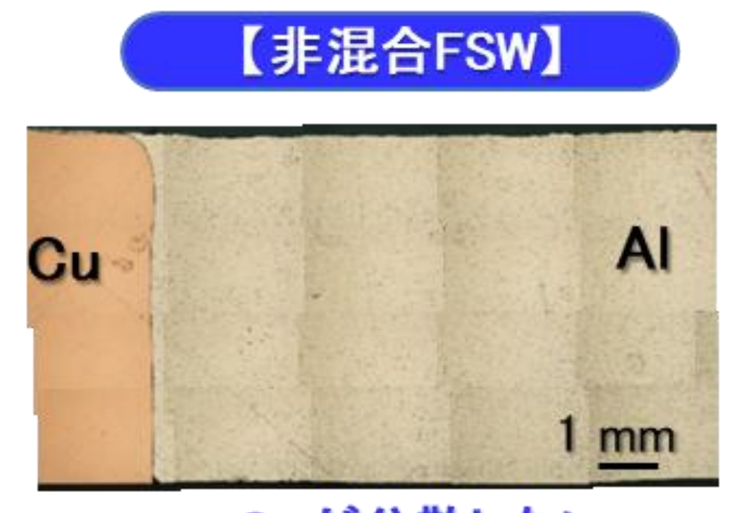
【非混合FSW】 Cuが分散しない未接合部、空隙がない化合物層が \mu\text{m} 単位
