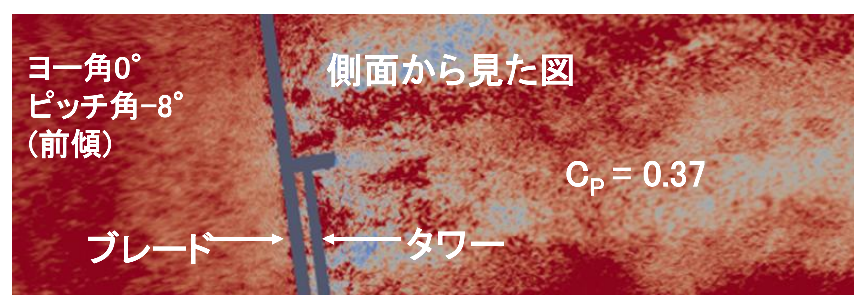
FOWTのピッチ角を変えた時のLES解析例
