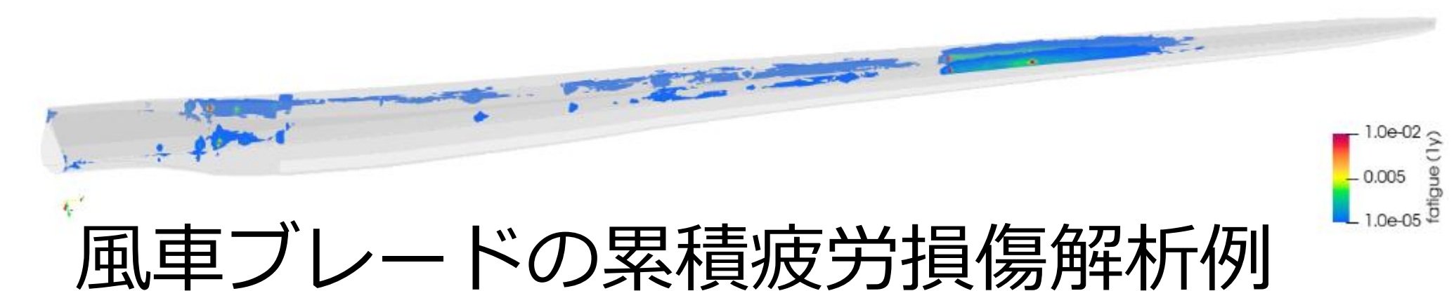
風車・浮体一体型の３次元FEMモデルによる構造応答解析例
