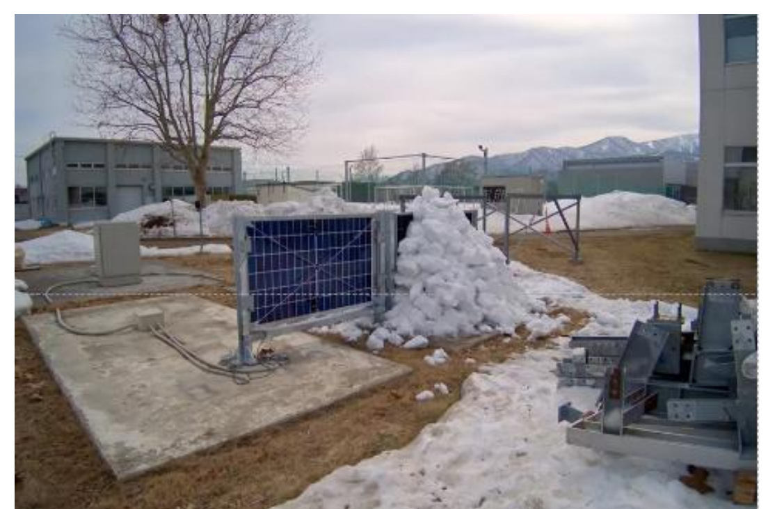
垂直設置の積雪荷重測定装置
