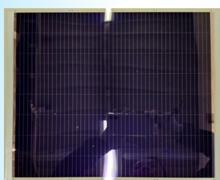
G2サイズ(37×47cm) フィルムモジュールの外観図
