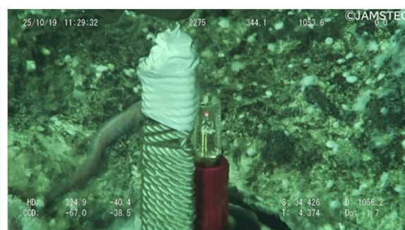
海底熱水の熱エネルギーによるLED点灯写真 (2026/2/26 商船三井プレスリリースより)
