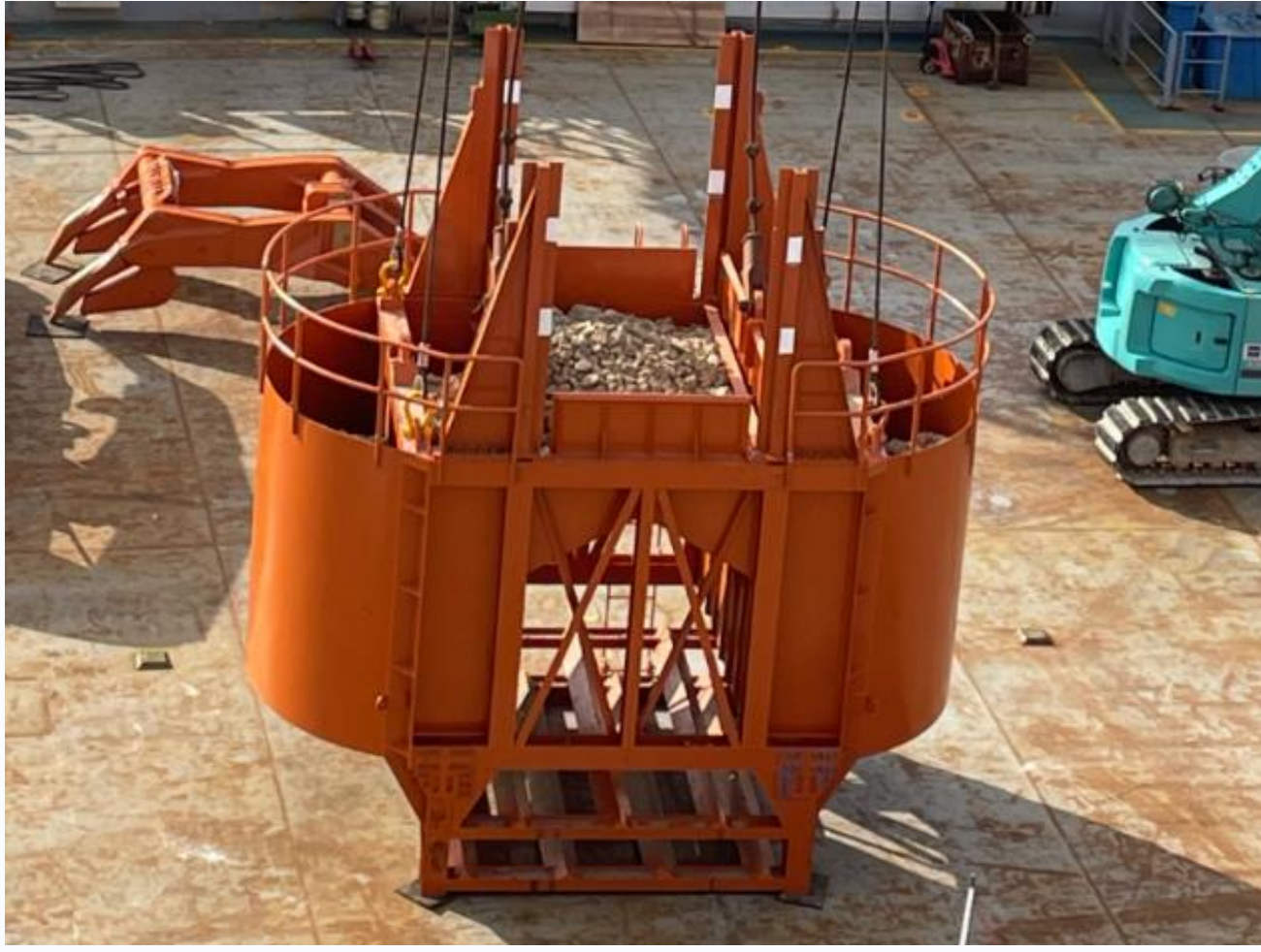
写真. 碎石防護装置
