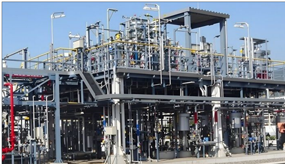
CO 2 法MDIベンチ設備（カルバミン酸エステル合成）
