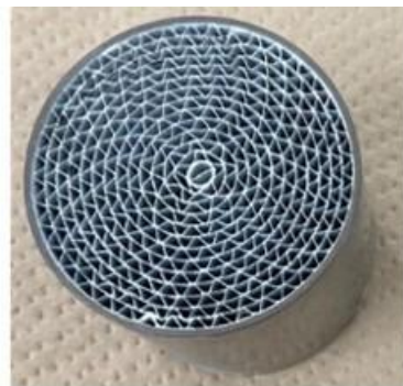
ハニカム固定化触媒 OD : 42mmφ×50mmL
