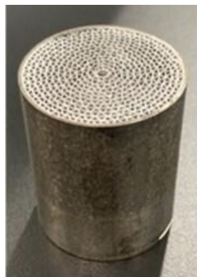
CS 2 O/SiO 2 触媒粉末を ハニカムに担持し気相反応 ベンチ用OD:42mmφ×50mmL (日本製鉄調製)
