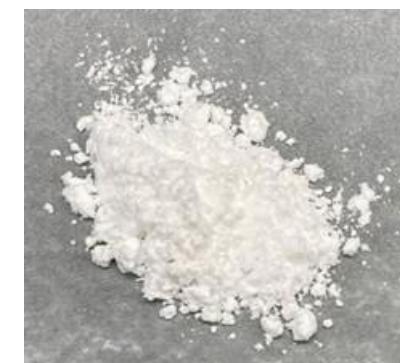
Cs 2 O/SiO 2 触媒粉末を 液相に懸濁し反応
