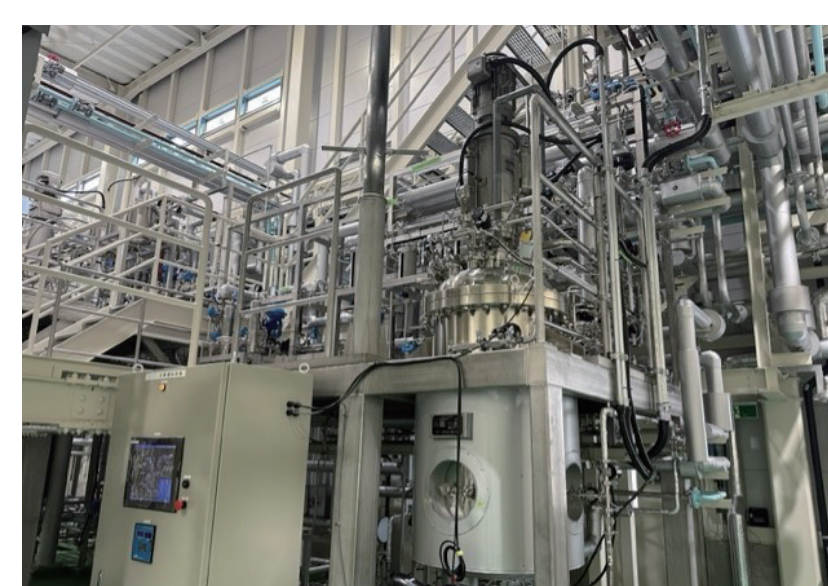
写真（右から 30L 培養槽、300L 培養槽、3000L 培養槽、前処理装置、防爆対応精製設備（300L 晶析槽））
