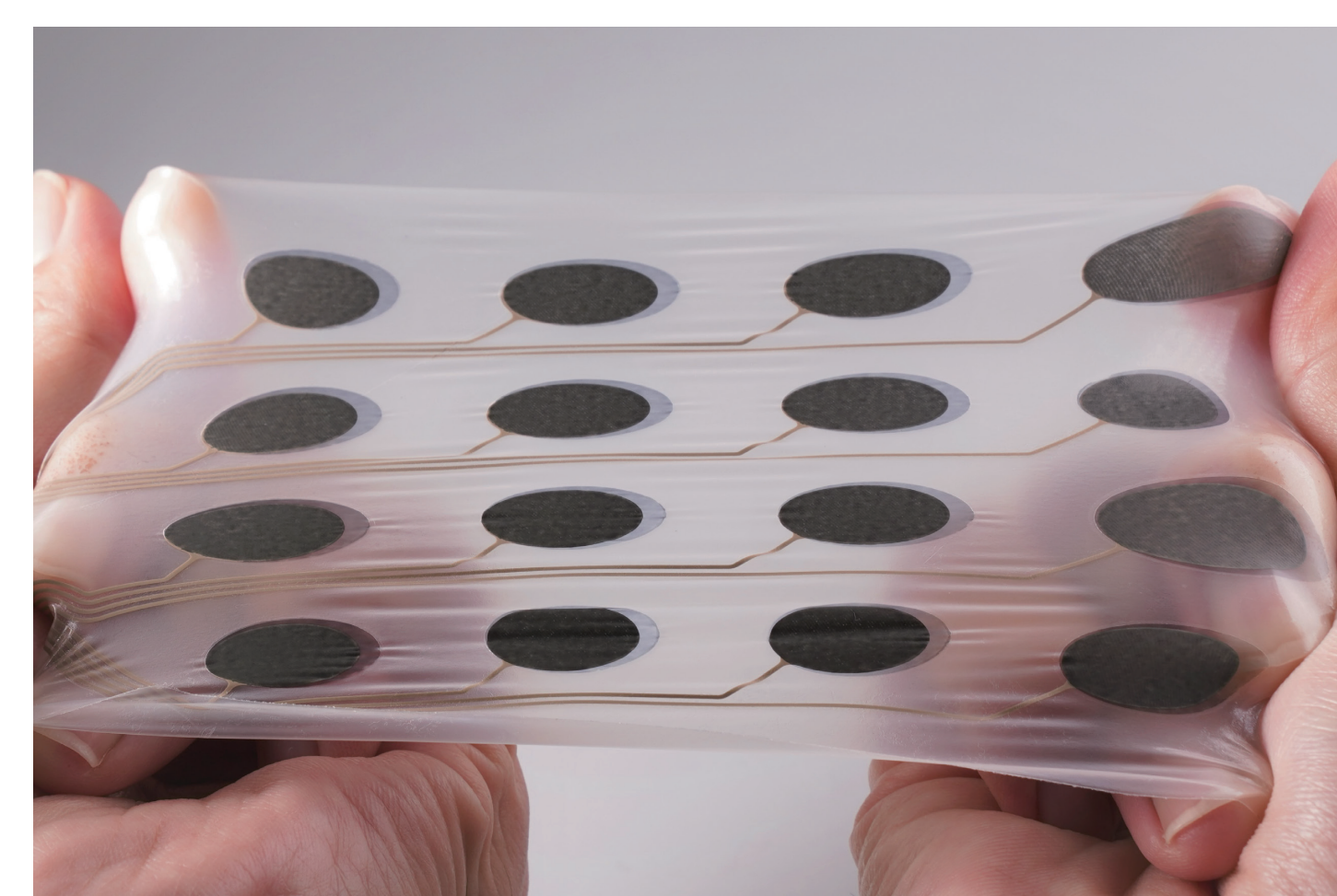
生体ドライ電極シート Biocompatible dry-type bioelectrode sheet
