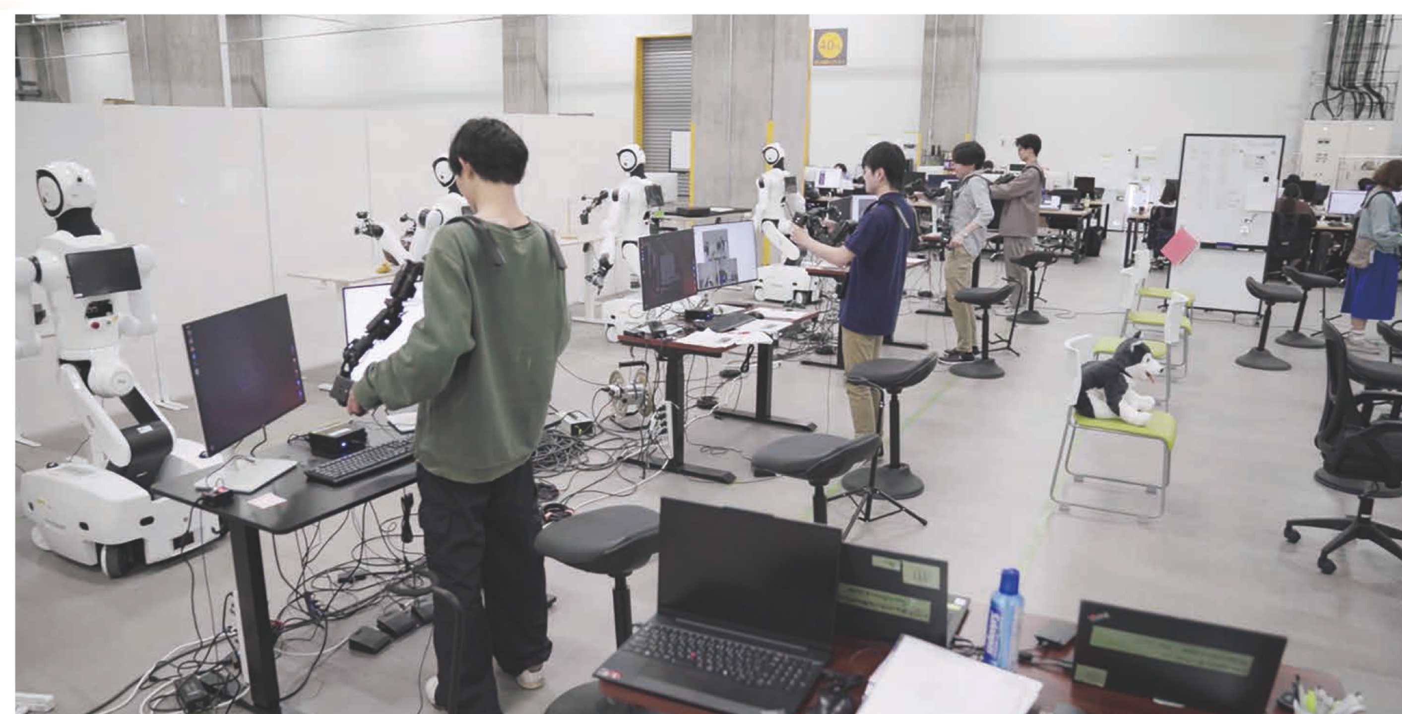
双腕モバイルマニピュレータを用いた ロボット動作データ収集
