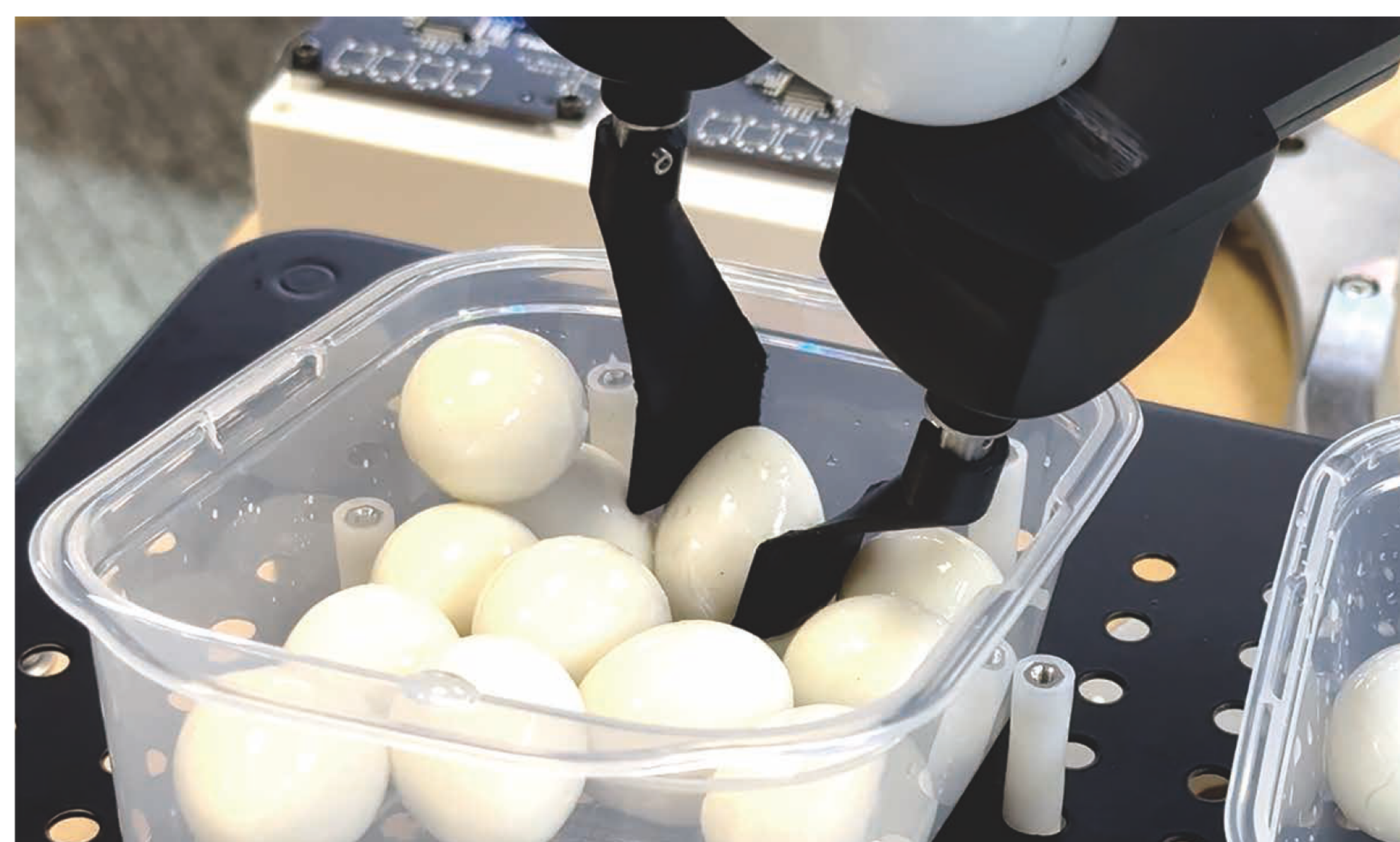
バラ積みされた食品の動的ピッキングの様子
