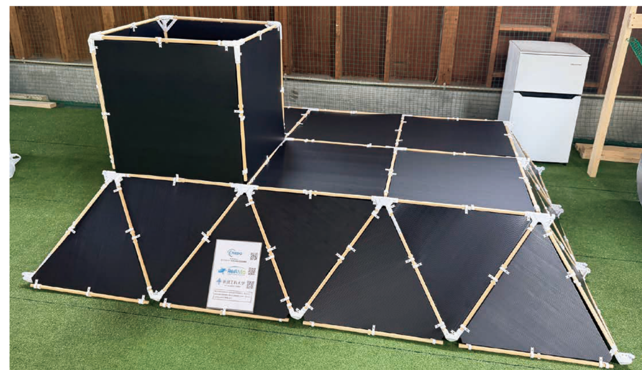
図2 床下等の点検を想定した試験環境構造体 ドローンメーカーにて活用中(2026年7月)
