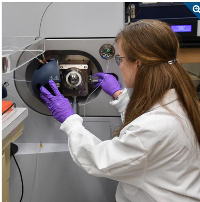
未知の化学化合物の同定に科学者らが使用する実験装置の質量分析計に試料を注入する NIST の研究者。
