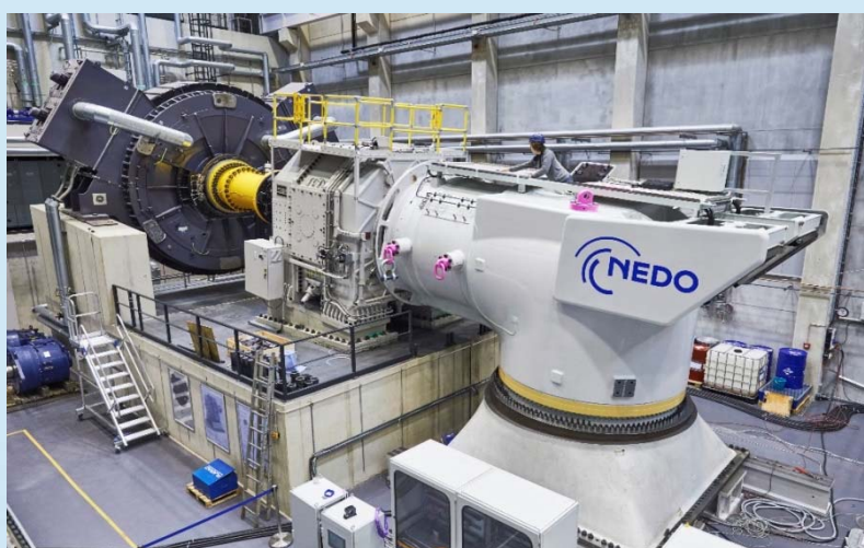
写真：フルロードテスト実施状況
