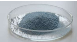
NPGM触媒 粉末サンプル
