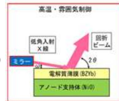
薄膜XRD測定/in-Situ XRD
