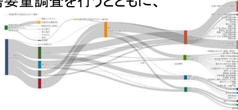
図3.2.1-6 横浜市のエネルギー需給フロー図(2019年)(報告書P.73)
