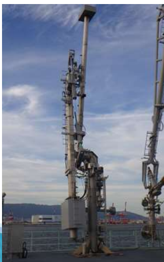
鋼管型ローディングアームシステム（拡大）
