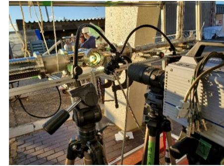
水素キャビテーション流動試験の様子 (JAXA能代ロケット実験場、一部既設)
