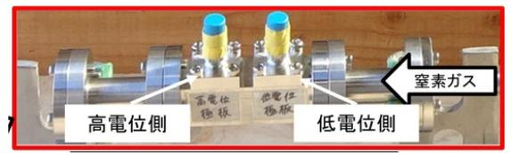
図1. オール金属タイプ極板型センサー
