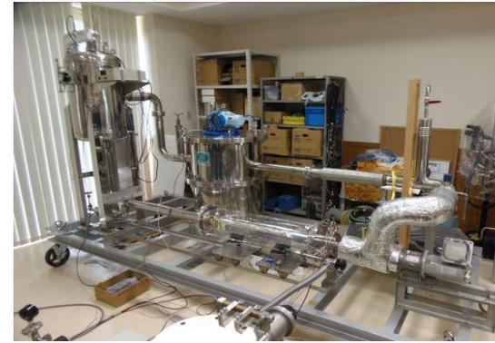
液体窒素循環試験設備
