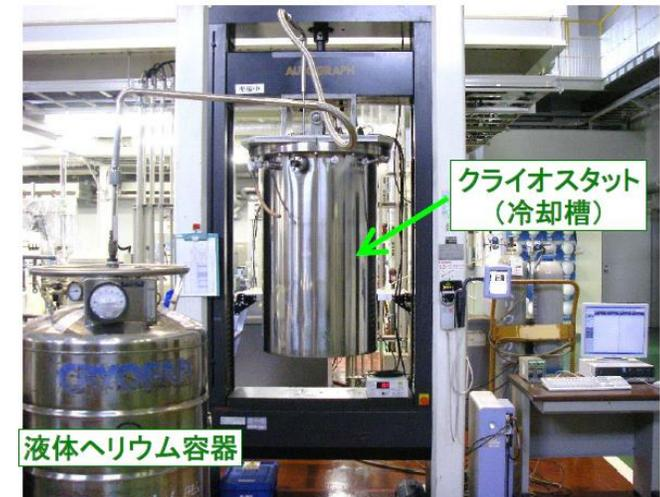
Fig. 極低温(4K)試験装置の外観
