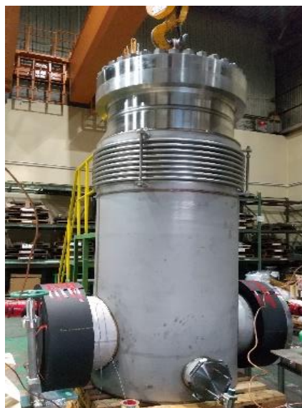
20インチ試作弁外観写真 左：ボール弁、右：チャッキ弁
