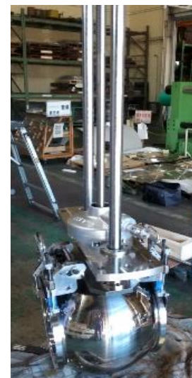
20インチ組立・分解治具外観写真 左：ボール治具、中：リテーナ治具、右チャッキ治具
