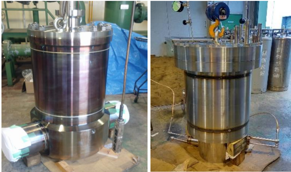
10インチ試作弁外観写真 左：ボール弁、右：チャッキ弁
