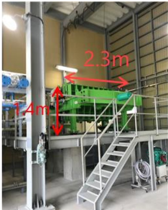
中型電解槽 (150kW級,30Nm 3 /h)
