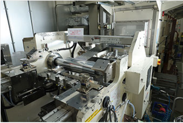
写真4 開発実証段階の電極塗工装置。電極スラリーを薄くかすれないように高速で塗布する
