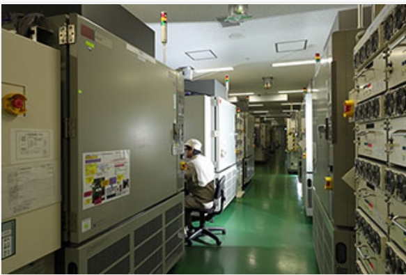
写真5 フロアいっぱいに並ぶ充放電試験装置。15,000回の充放電後も80%以上の容量を保持する
